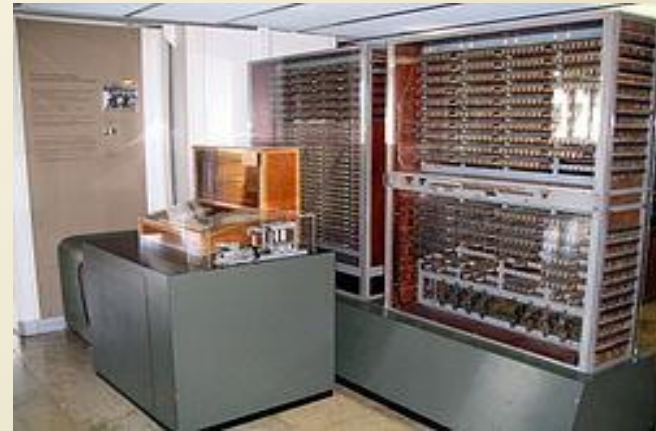
Z-3 elektro-mexaniki hesab maşını (Konrad Zuse)
